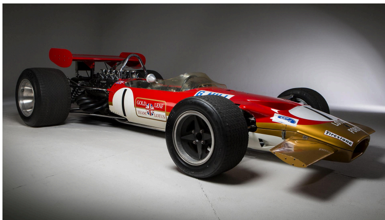
Imatge 2. Lotus 49, el primer Fórmula 1 de la història amb alerons. Extreta de Car Pixel
