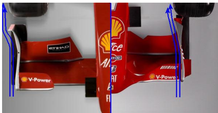
Imatge 16. Efecte d'outwash (fotografia esquerra) i d'inwash (fotografia dreta) a un ala davantera. Extreta de: F1 Dictionary
