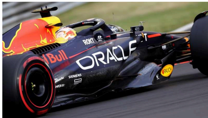
Imatge 22. Pontons del RB19. Extreta de: DAZN
