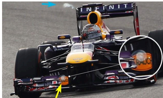
imatge 10. Creació de vòrtex tant a les puntes de l'ala davantera com posterior. Extreta de: F1 Tech Blog-WordPress.com
