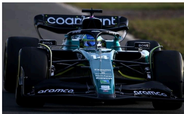
Imatge 20. Halo i retrovisors. Extreta de: Motor.es
